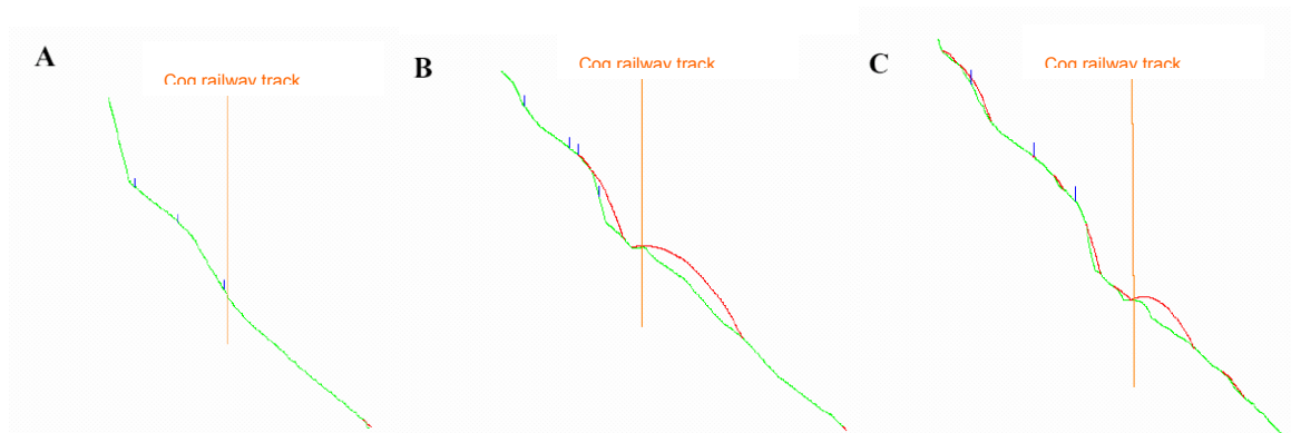
Figura 20: perfiles longitudinales del desprendimiento de abril de 2003, obtenido mediante el modelo 3D con diferentes tamaños de malla. A: 15x15, B: 8x8, C: 2x2.
