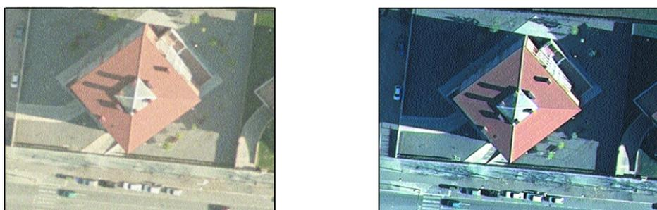
Fig 1. Comparación de dos fotografías de la misma escena, tomadas simultáneamente durante el mismo vuelo con una cámara RC30 (izquierda) y DMC (derecha) durante los vuelos de aceptación en Diciembre del 2004. Nótese el aumento de la nitidez de la imagen digital y la práctica ausencia de ruido. La imagen digital es de 8 bits.
