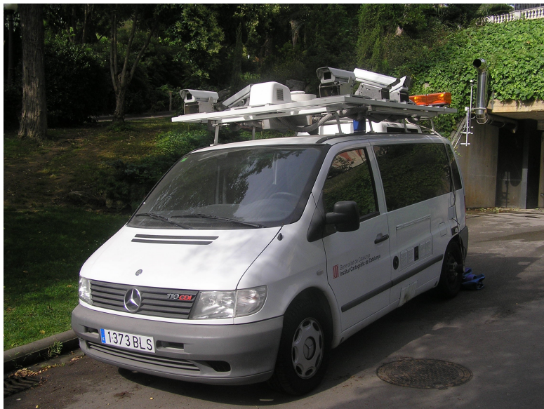
Figura 1: El Sistema GEOMÒBIL del ICC.
