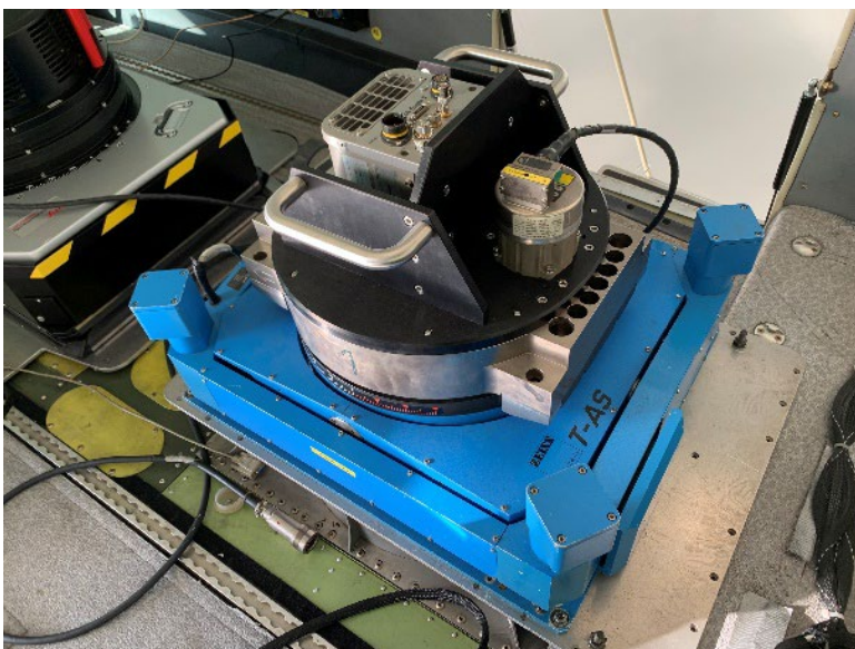
Projecte NOSA. Adaptador de sensor AISA a la plataforma estabilitzada TAS.
