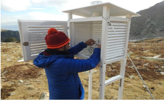
Muntatge de l'estació nivometeorològica de Vallter-Marmotes, la tardor de 2021, amb l'objectiu de monitoritzar diferents variables relacionades amb l'estabilitat del mantell nival, les condicions atmosfèriques i l'observació d'allaus.
