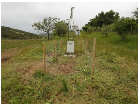
Nova ubicació, al municipi de Tremp, de l'estació Clot de les Peres de la Xarxa Experimental de mesura de paràmetres físics del sòl, que havia quedat inutilitzada pels efectes de la borrasca Gloria.
