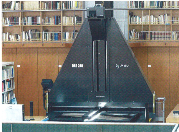
Figura 2: Equipo de digitalización Metis DRS2A0 del ICC, con capacidad para digitalizar originales de hasta 120x180 cm a 300 ppi.
